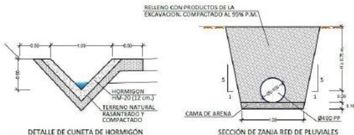
Imagen 22 Sección tipo de cuneta y zanja de colector de pluviales
