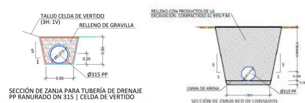
Imagen 19 Zanja tipo tubería de drenaje y de red de lixiviados
